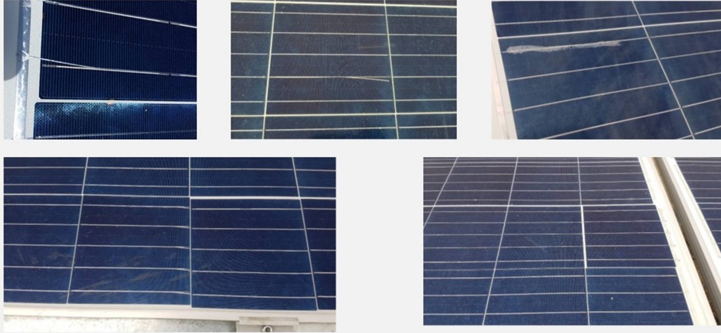
Panel üretiminde kaymalar, ribon sorunları, laminasyon hataları
